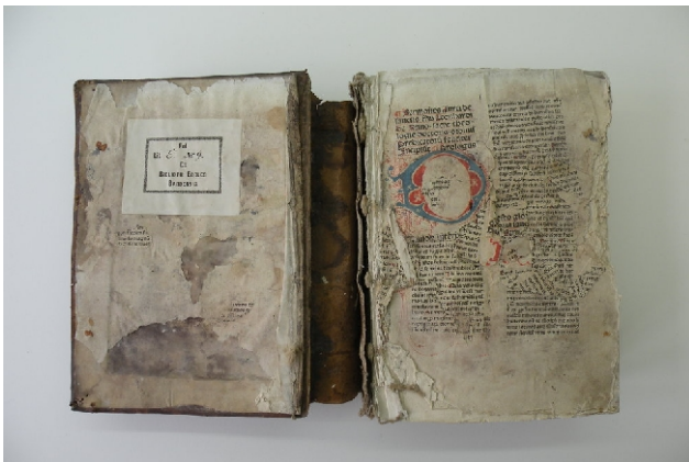
Foto 3: vorderer Buchdeckel; Innenseite / Spiegel und Buchblock – sehr stark abgebaute Papierfasern
